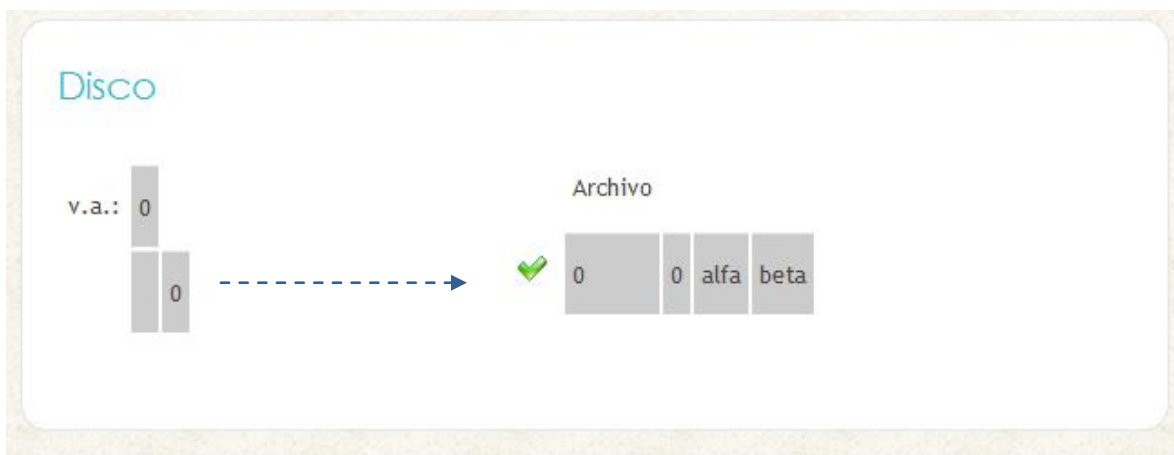
Figura 5.22. Inserción sin desborde. La llegada de las claves alfa y beta van al único lugar de memoria disponible, completando la misma en su capacidad total.
