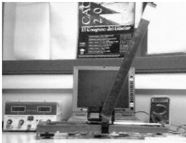
Fig. 9 - Sistema físico que implementa al péndulo invertido
