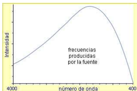
Fig. 6.8: Distribución de intensidad de la fuente de radiación infrarroja del espectrómetro FTIR
