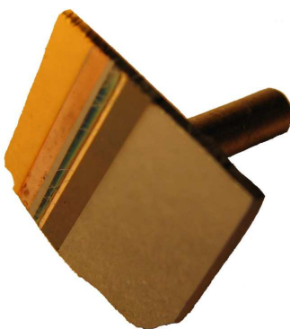
Fig. 4.17: Calibrador multielemental. Consiste en un cristal de silicio en el que se han depositado franjas de plata, nitruro de titanio y simil diamante
