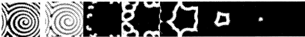
Figura 2-7-15. Evolución del sistema con dependencia cuadrática negativa a partir de una espiral inhomogénea. Los parámetros de evolución son k_{uu} = -4 y \epsilon = 0.06 . Estado inicial (imagen de la izquierda) obtenido a partir de un estado inicial de espiral inhomogénea debido al efecto Doppler. Este comportamiento se observa hasta valores de \epsilon \approx 0.10 .
