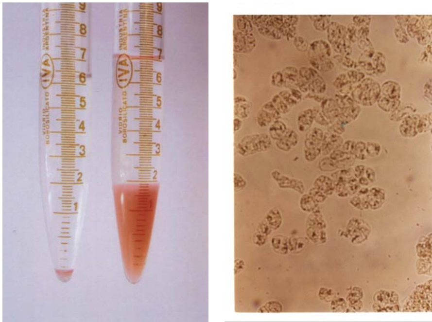
Figura 4.14. A: Fotografía de macerado de cilindros escaldados por PGI (derecha) y control (sin enzima). Las condiciones de maceración son detalladas en la Figura 4.13. B: Microfotografía de macerado de zanahoria con PGI de A. kawachii (10 ×).
