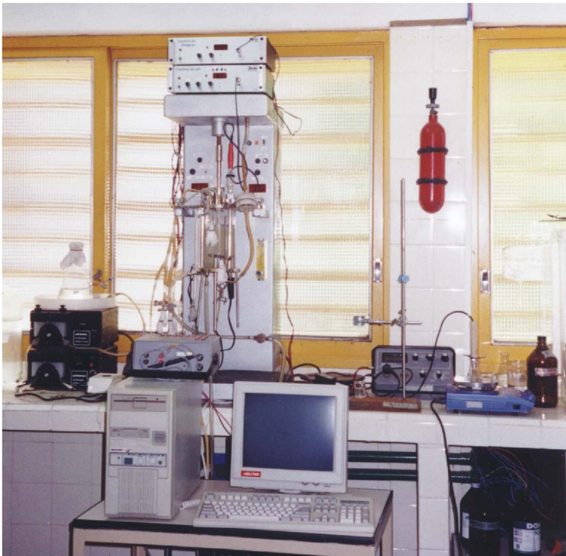
Figura 4.1. Biorreactor utilizado durante las experiencias de cultivo continuo y batch
