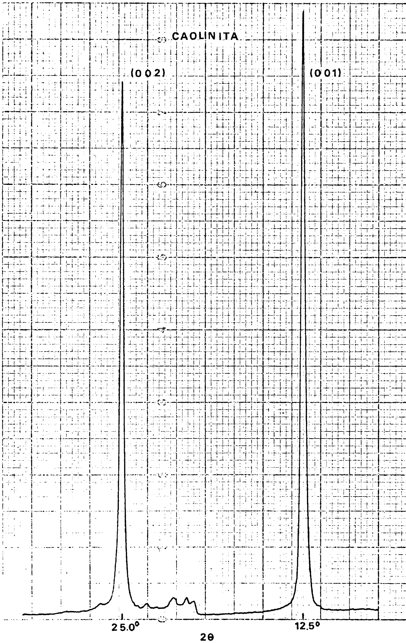
Figura V.4: Caolinita: Picos correspondientes al primer y segundo orden de difracción de los planos (001) (escala de intensidades arbitraria).
