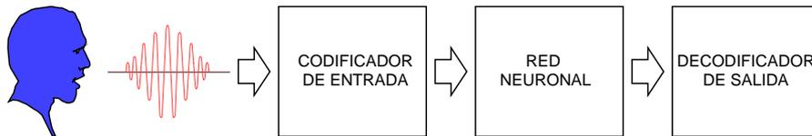
Para la grabación de archivos sonoros se han utilizado formatos estándar VOC y WAV, en sistema MONO, con una resolución de 8 bits y frecuencia de muestreo variable, de la cual nos independiza el módulo codificador de entrada.
