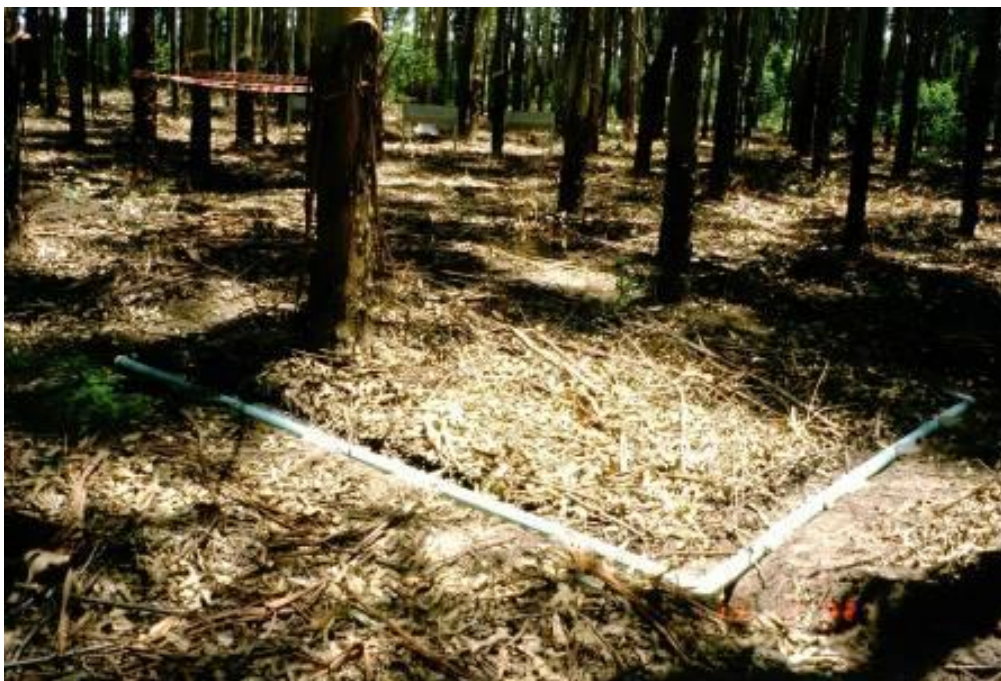
Figura 2.6: Parcela para la medición del escurrimiento superficial. Obsérvese la canaleta colectora dispuesta a lo largo de 3 de los 4 lados de la parcela. El recipiente colector (no visible) se encuentra en el ángulo inferior derecho de la foto.
