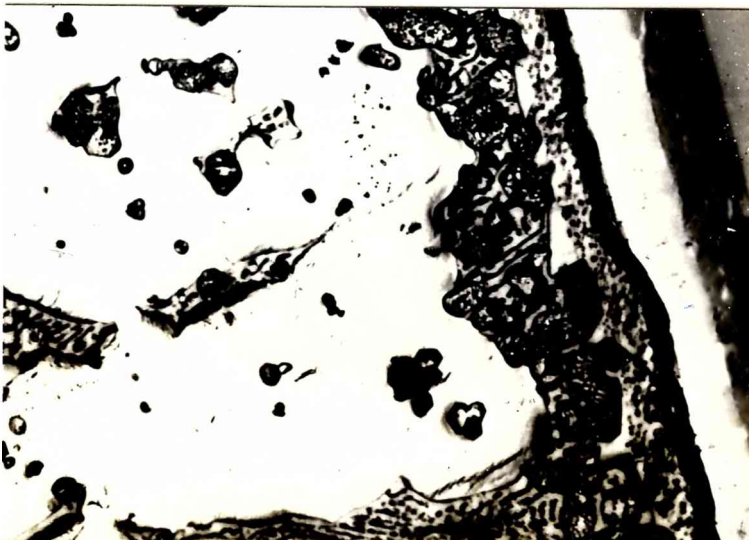
15c Zr_{23}Fe_{77} . 1415°C borde de muestra. Se observa Ta y zona intermedia con ZrFeTa .
