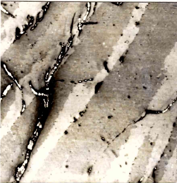
11c Muestra 3. 1450°C - 3hs. Fase: hexagonal. 100X
