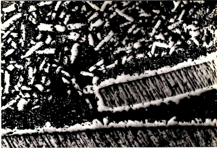
18a Zr_{15}Fe_{85} . 1345°C Fases: relieve ZrFe_2 , bajorrelieve eutéctico que al fundirse se coló en un doblez de Ta Hay zona de ZrFeTa 100X
