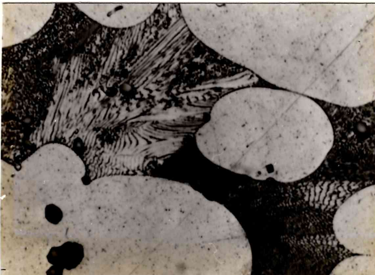
20c Zr_4Fe_{96} . 1325°C Fases: Similar a 20b, eutéctico inhomogéneo, fundió 1000X
