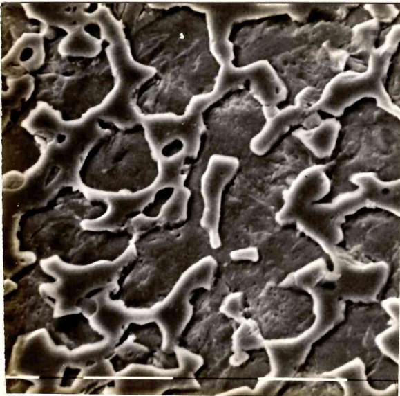
13c Material tratado a 1230°C Fases: bajorreliieve ZrFe_2 relieve Zr_6Fe_{23}+Fe(\alpha) 10 \mu m
