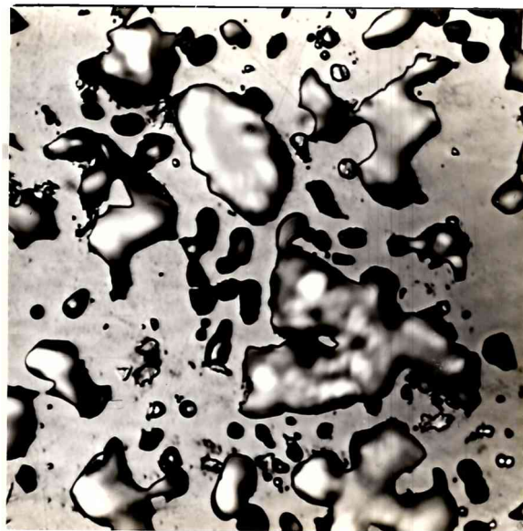
12d Zr_{15}Fe_{85} . 1230°C- 67hs. Fases: similar 12c. Se observa poca evolución. 1000X
