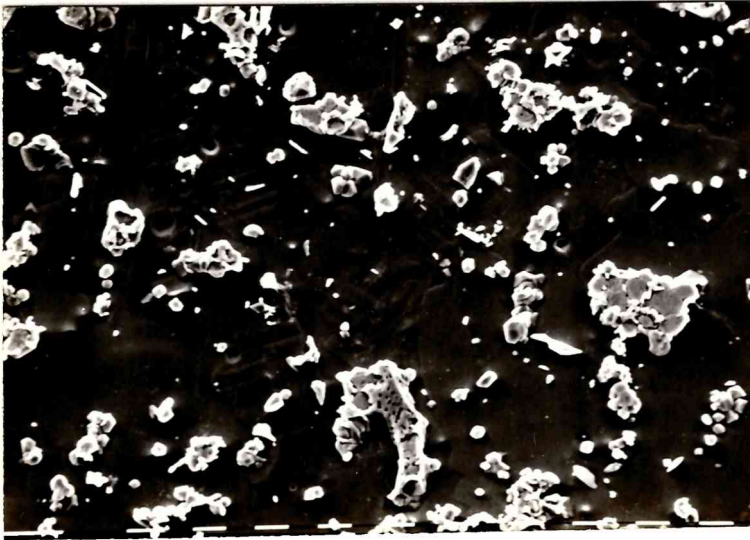
16a Fases: bajorrelieve ZrFe_2 relieve Zr_6Fe_{23} + Fe(\alpha) (eutéctico)
