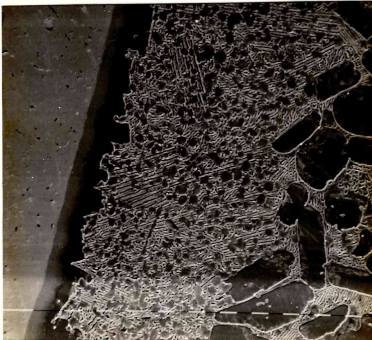
19b Borde con Ta de la muestra de 19a. Se observa zona intermedia de ZrFeTa entre el Ta y la muestra 10\mu m
