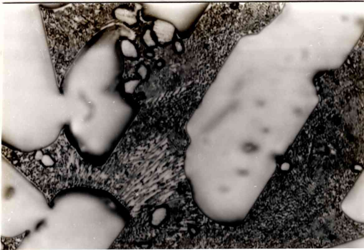
Fig.20 Micrografías ópticas con mayores detalles del material tratado a temperatura cercanas a la eutéctica
