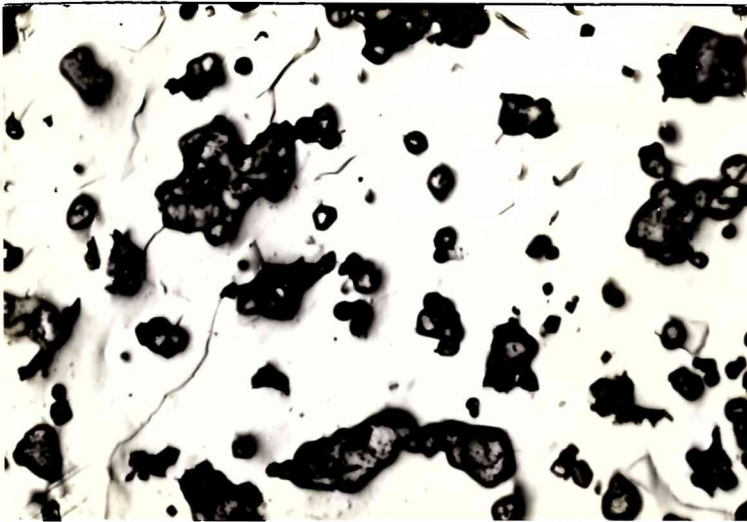
15a Zr_{25}Fe_{75} . 1415°C Fases: bajarrelieve ZrFe_2 relieve Zr_6Fe_{23} y algo de eutéctico.
