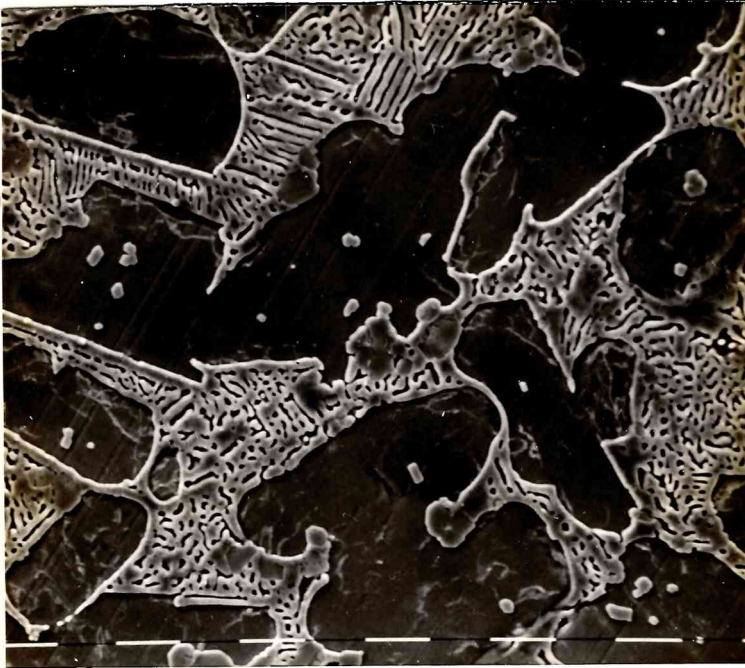
19a Fases: bajorrelieve ZrFe_2 relieve eutéctico y zonas aisladas de Zr_6Fe_{23} 10\mu m
