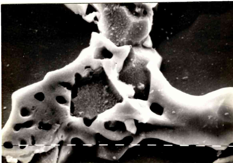
16b Detalle de 16a bajorrelieve ZrFe_2 relieve Zr_6Fe_{23} y Fe(\alpha) (zona blanca)
