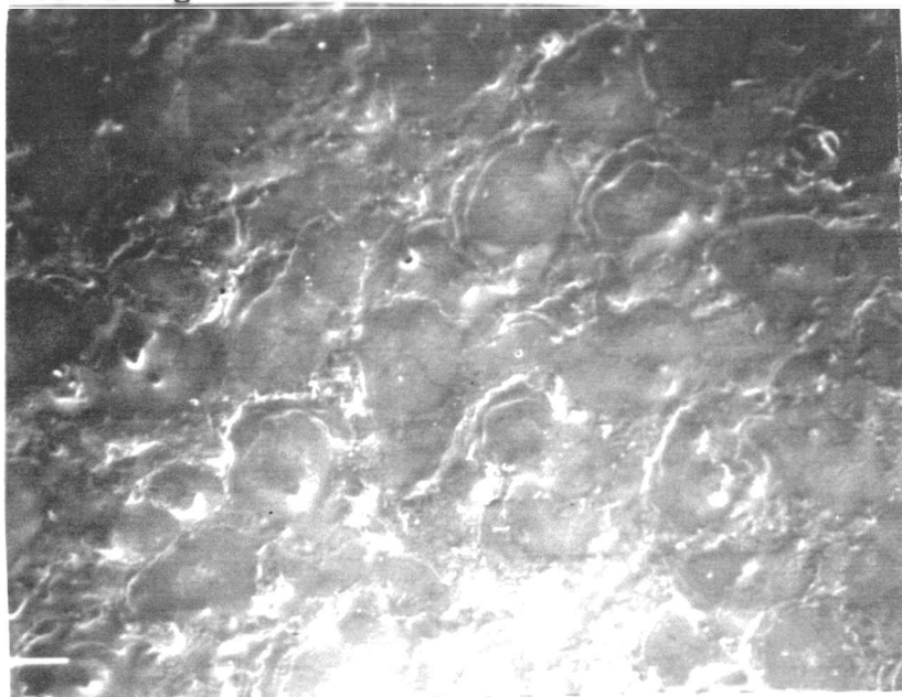
Fig.44 Cráteres aplanados en S16, micrografía 6622/4, 57x.
