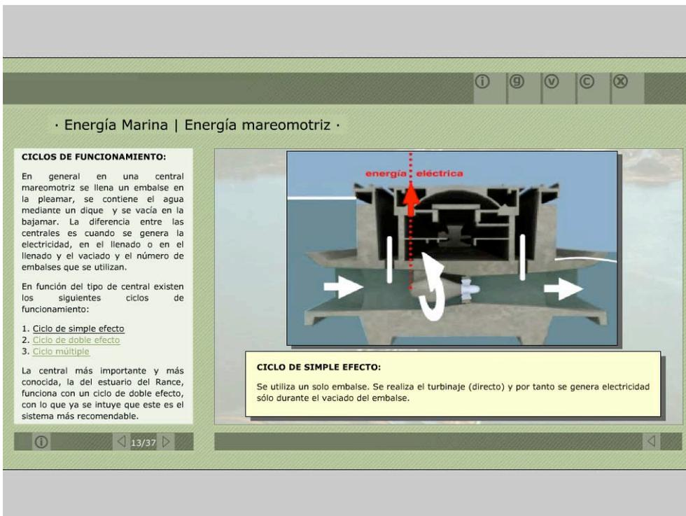
Fig. 8 Animación 2D sobre los ciclos de funcionamiento de una central mareomotriz.
