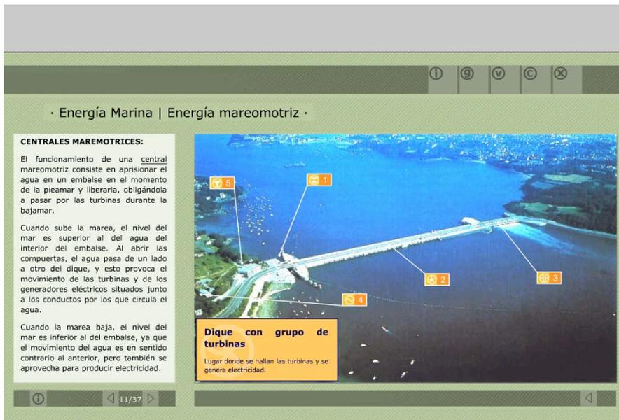
Fig. 5 Partes de una central mareomotriz
