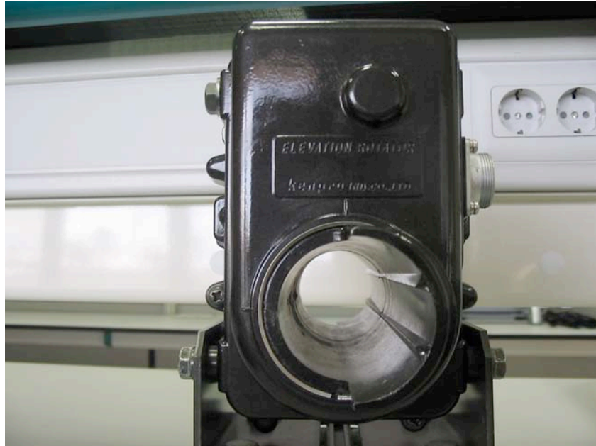
Figura 8: Imagen ampliada del rotor de antenas en el que se aprecia el orificio en el que se introducirá el mástil metálico cilíndrico al que se fijará la antena bajo medida.
