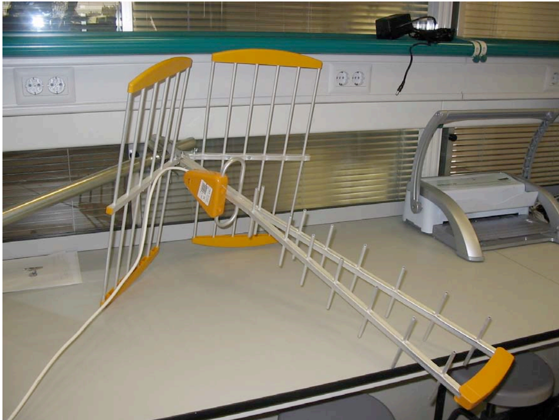
Figura 9: Imagen de la Antena de UHF Monolítica Ref. 1243 sujeta a un mástil metálico.
