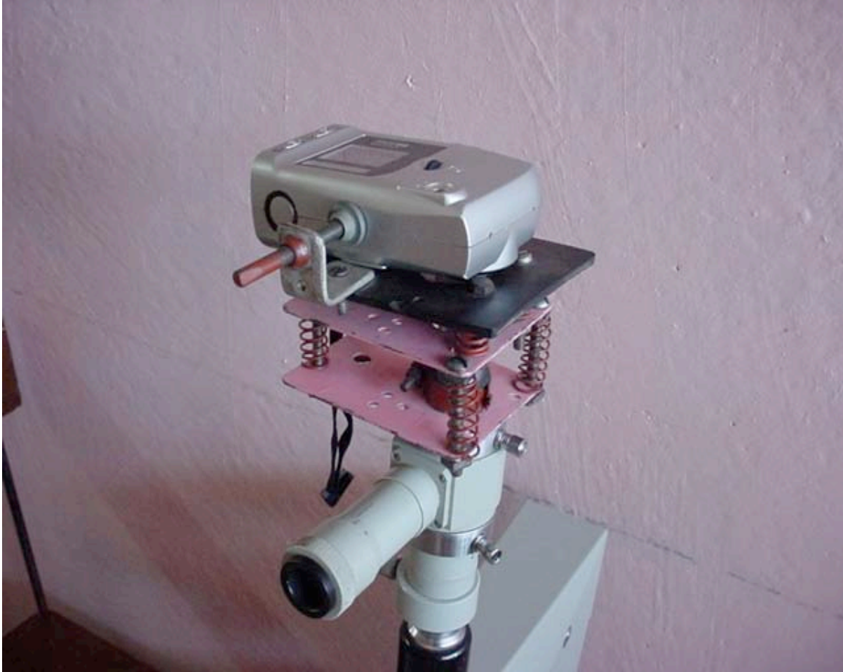
Figura 2: Adaptador de cámara digital para microscopio y estereoscopio.
