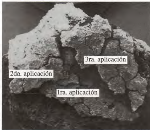
Figura 3. Fotografía de la cara interna de un fragmento de crisol, donde es posible apreciar tres diferentes capas superpuestas de la sustancia blanquecina observada en la mayoría de los artefactos refractarios. Cada aplicación permitió la reutilización del serrefacto prolongando su vida útil (microscopio electrónico de barrido a 50x) (extraído de Campo 2001)
