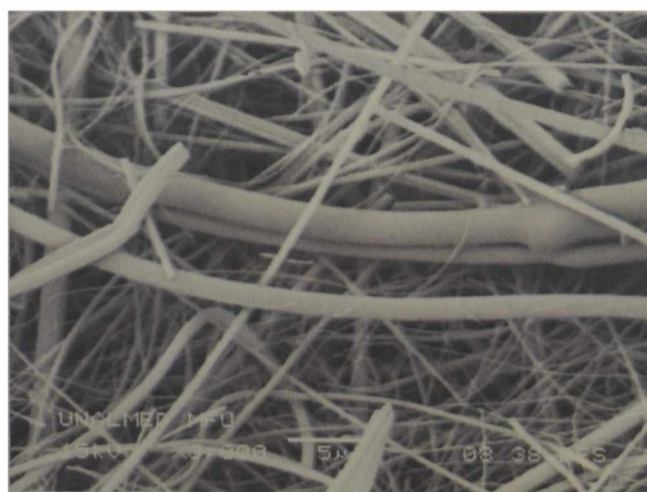
Figura 3.2. Microfotografía electrónica de barrido de un MFV con binder . La línea en la microfotografía indica una longitud de 5 \mu\text{m} .
