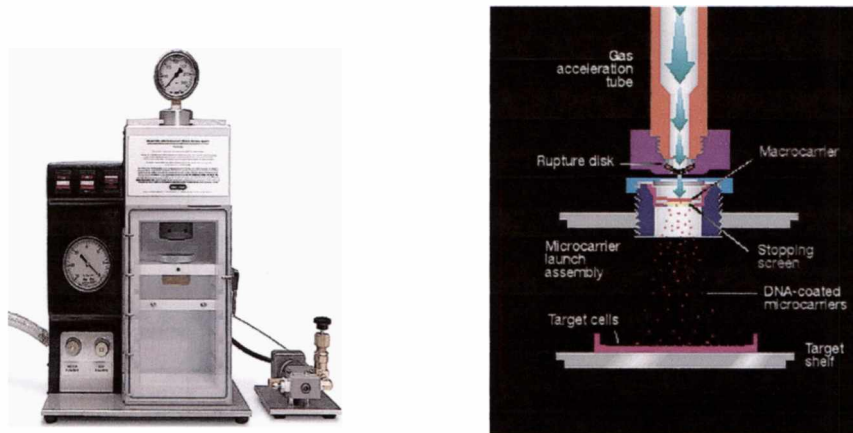
Figura 3: Cañón para disparar partículas de BioRad y esquema de funcionamiento Glass acceleration tube: tubo de aceleración de vidrio, Rupture disk: disco de ruptura, Microcarrier launch assembly: ensamblaje del propulsor de las micropartículas, Stopping screen: retentor del disco de ruptura, DNA-coated microcarriers: micropartículas recubiertas de ADN, Target cells: células blanco, Target shell: estante donde se pone la muestra blanco.
