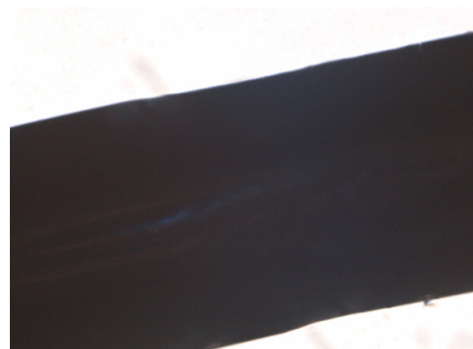
Foto 18: Muesca en aguja quirúrgica 3/8 círculo, reverso cortante 24mm. Sutura comercial nylon 2/0 con aguja Surgicon.
