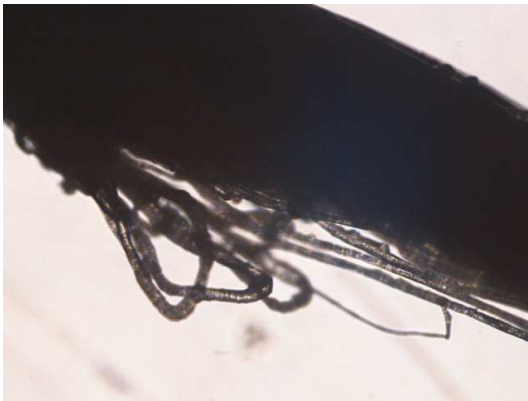
Foto 13: Vista microscópica de una alteración percibida como un nódulo a simple vista. Sutura artesanal de lino 40.
