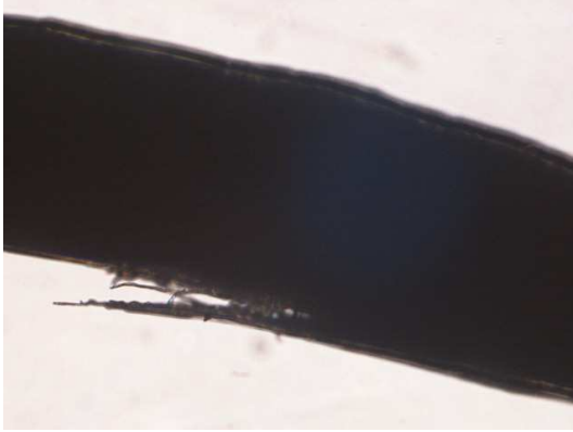
Foto 11: Hebra de lino sin alteraciones a simple vista. Presenta deshilachamiento al microscopio. Sutura artesanal de lino 40.
