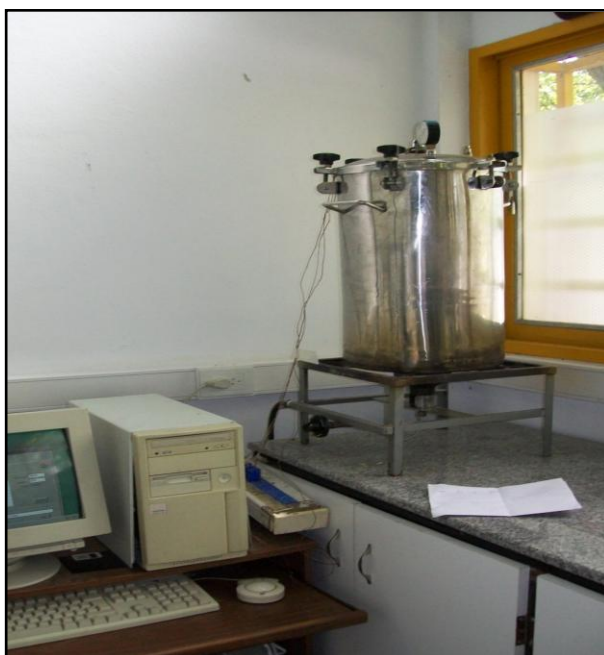
Figura 2.1. Autoclave utilizado para el tratamiento térmico y equipo de control de temperatura durante la manufactura de patés de hígado de pollo
