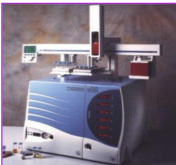
Figura 2.13. NE-MS Alpha Prometheus (Alpha MOS ® , Francia) y condiciones del análisis
