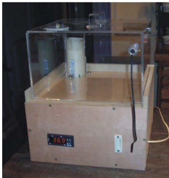
Figura 28: Incubadora utilizada para elevar la temperatura de las ratas previo a la determinación de presión arterial para lograr una óptima visualización del pulso en la arteria de la cola. El sector inferior de madera contiene la fuente de calor y el termostato cuyo panel digital se ve abajo y a la izquierda. El sector superior de acrílico tiene una tapa corrediza por dónde se introduce la rata, y el conjunto es fácilmente desmontable para su limpieza. No se muestra en la figura un enrejado de acrílico que mantiene al animal a una cierta distancia del piso inferior de la incubadora, permitiendo rellenar ese espacio con viruta para su limpieza.
