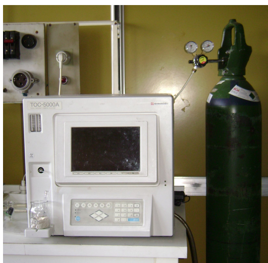
Figura 2.3. Equipo utilizado para las determinaciones de Carbono Orgánico Total
