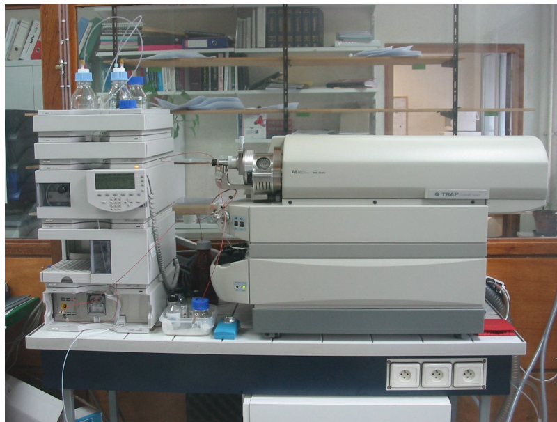
Figura 7.2. Equipamiento utilizado en las determinaciones HPLC-MS
