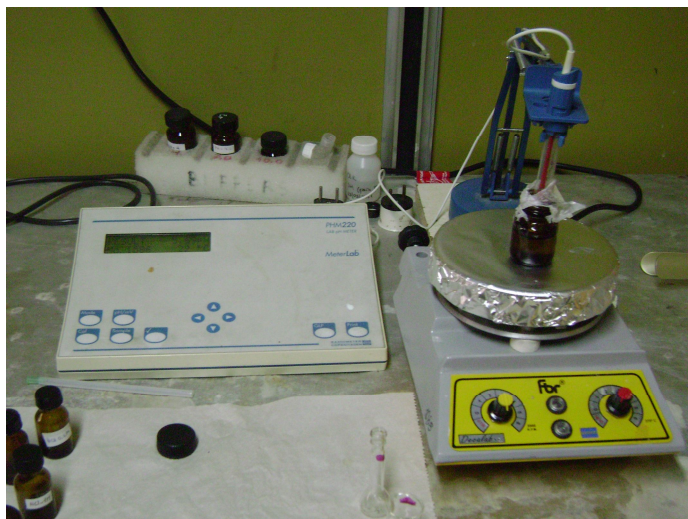
Figura 2.5. Equipo empleado para realizar las medidas de pH
