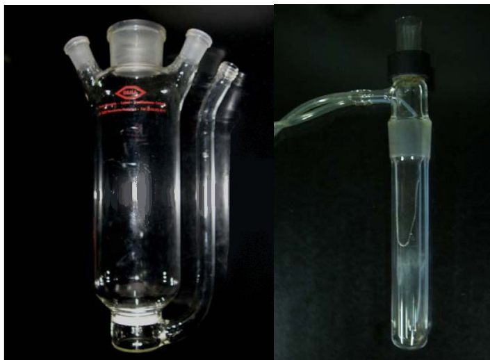
Figura 6.2. Reactor fotoquímico y camisa de cuarzo utilizados en los ensayos
