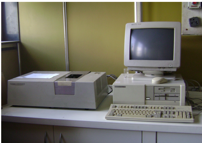
Figura 7.1. Equipo de simple haz utilizado para medidas espectrofotométricas
