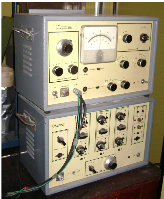
Figura 5.2. Potenciostato utilizado en los experimentos electroquímicos
