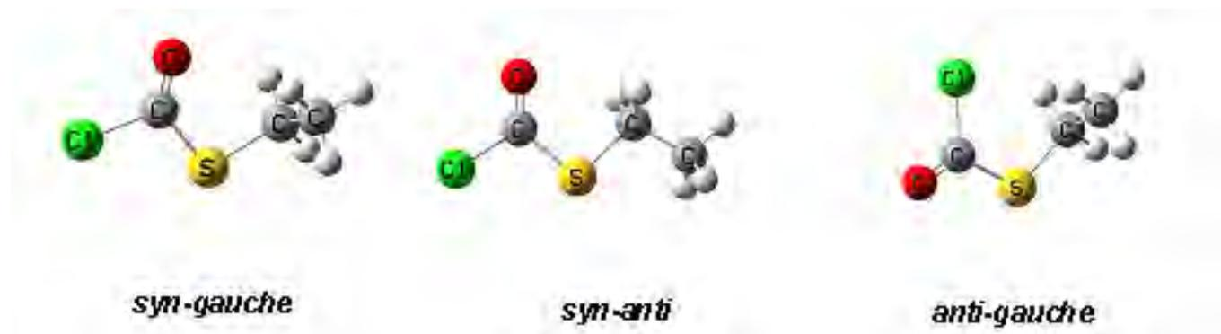
**Figura 4.2.** Diagrama molecular de los conformeros esperados para la molécula  $\text{ClC}(\text{O})\text{SCH}_2\text{CH}_3$ .
