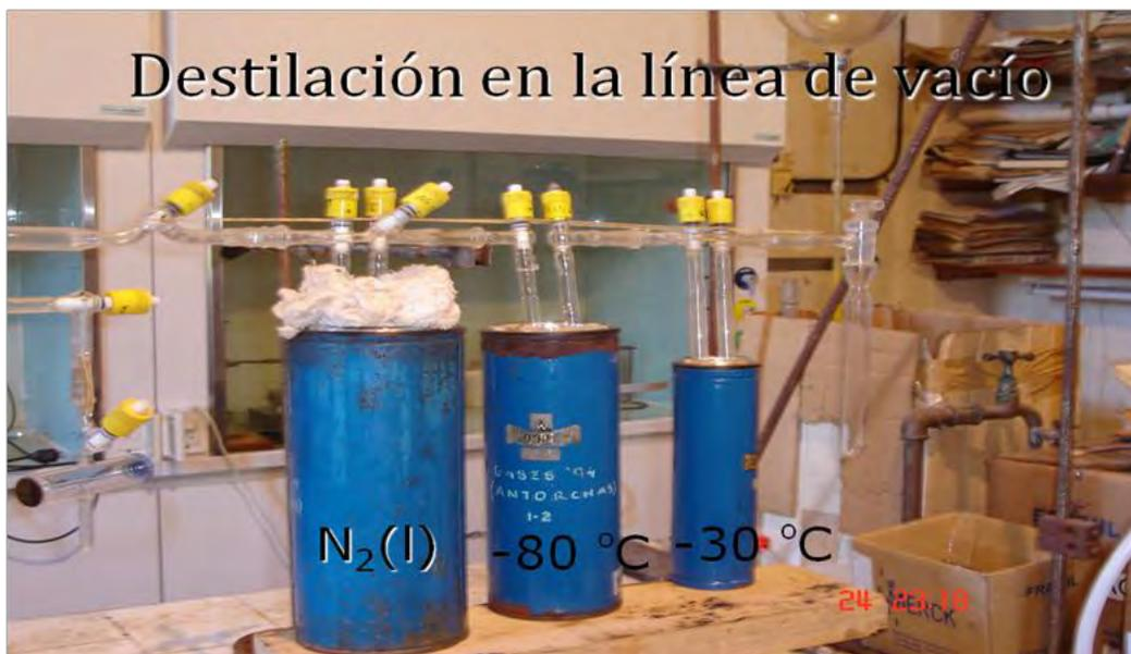
**Figura 4.3.** Tren de trampas típico utilizado para destilar las sustancias en la línea de vacío.
