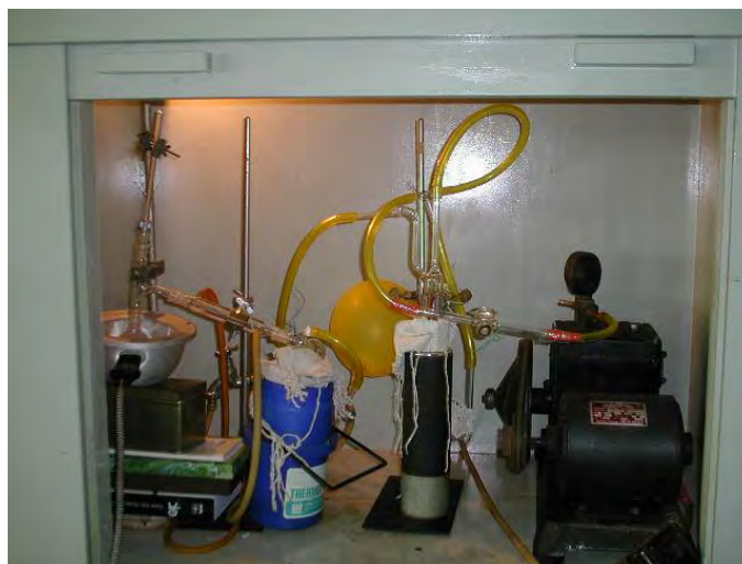
Figura 2.10. Dispositivo utilizado para la destilación de anilina a presión reducida.
