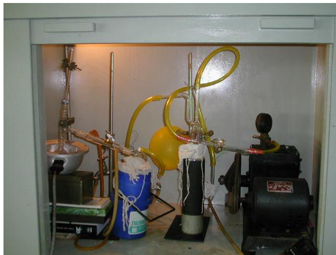
Figura 2.10. Dispositivo utilizado para la destilación de anilina a presión reducida.
