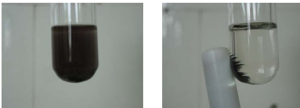
Figura 7.3. Catalizador \text{CuFe}_2\text{O}_4 durante la reacción, y la eliminación por parte del imán externo.
