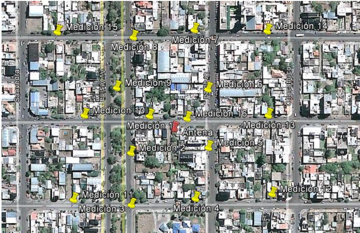
Figura 2. Plano de medición. Punto rojo: antena, puntos amarillos: puntos de medición
