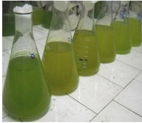
Figura 1b. Tratamiento con diferentes concentraciones de agua oxigenada: 0%, 0.0015%, 0.0030%, 0.0075%, 0.0150% y 0.0300% de H_2O_2 luego de 48 horas de exposición.
