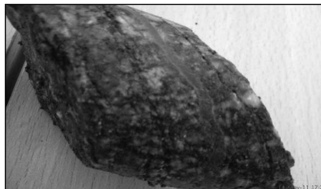
Figura 15. Control de la inyección. Lechada fraguada relleno fisuras en fragmento de testigo de perforación (gneis alterado y cizallado).
