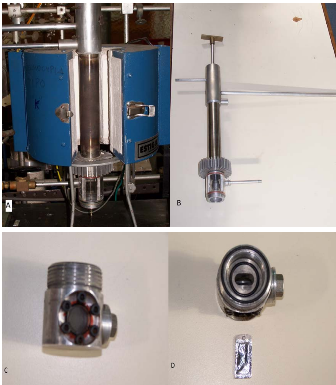
Figura 2.10 - A)Reactor montado dentro del horno, B)Reactor completo fuera del horno, C)Celda con ventana de acrílico, D)Porta muestra que se inserta dentro de la celda para su transporte en atmosfera controlada.
