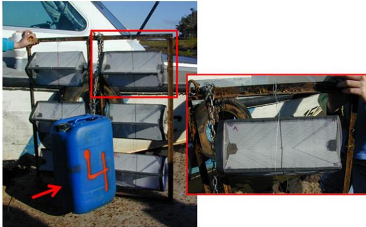
**Figura 3.** Monitor con 6 muestreadores cubiertos con malla de 1 mm de abertura y boya que lo mantendrá a flote.
