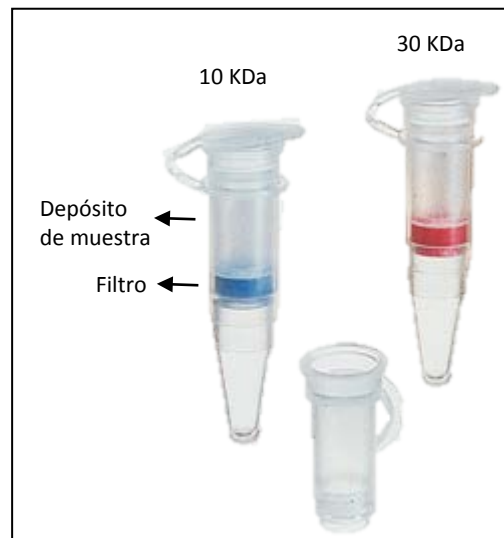
Fig. 4: Dispositivos de microfiltración. Nanosep (Pall Corporation®). Los valores consignados sobre los tubos corresponden a los tamaños de exclusión.
