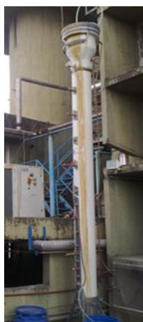
Figura 1. Digestor UASB estudiado.
