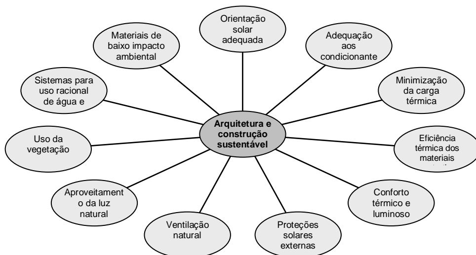
Figura 2. Diretrizes de Arquitetura e Construção Sustentável dos Espaços Públicos Fonte: baseado em http://www2.camara.gov.br/responsabilidade-social/ecocamara Figure 2. Guidelines for Architecture and Sustainable Construction of Public Areas. Based in http://www2.camara.gov.br/responsabilidade-social/ecocamara
