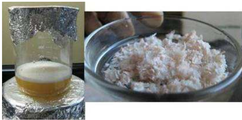
Figura 7.5 Quitosano obtenido a partir de la quitina del exoesqueleto de O. trimaculatus tratada con NaOH al 40%.
