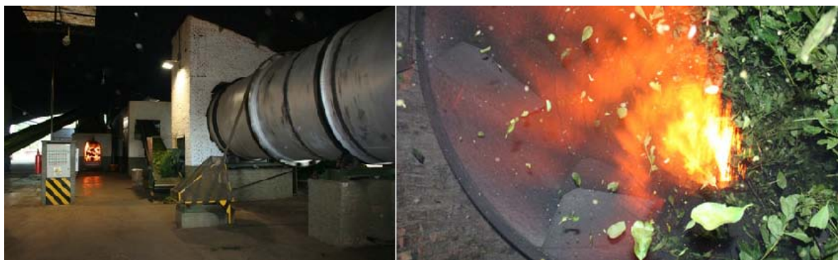
Figura 2.5: Horno rotativo cilíndrico donde se realiza el sapecado. Proceso de sapecado. Fuente: INYM
