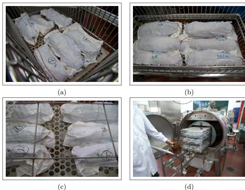
Figura 2.15: Músculos Semitendinosus bovino en los estantes del canasto del autoclave con ducha de agua marca Steriflow Barriquand Modelo Microflow. (a) Estante Inferior. (b) Estante Medio. (c) Estante Superior. (d) Ingreso del canasto a la cámara del autoclave.
