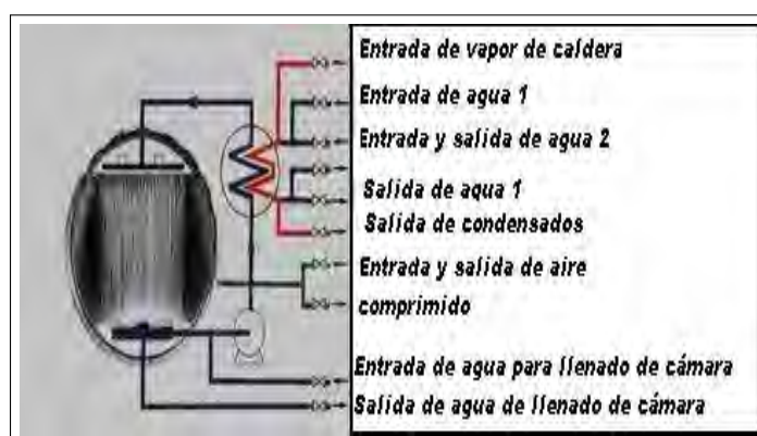
Figura 1.7: Autoclave horizontal con ducha de agua en escala piloto. Fuente: ?
