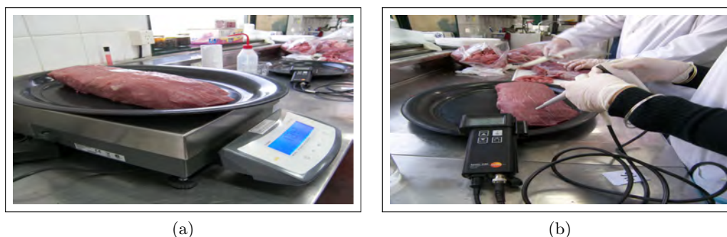
Figura 2.26: Determinación de peso y pH en músculos Semitendinosus bovino crudos. (a) Determinación de peso de la pieza cárnica (b) Medición de pH en el extremo distal de la pieza cárnica.
