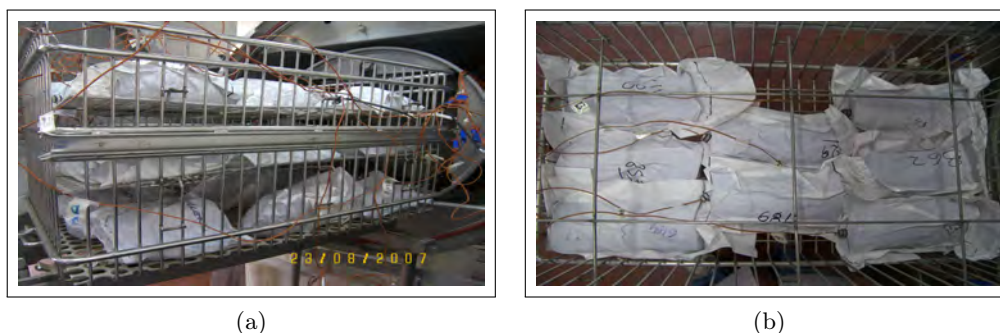
Figura 2.13: Ubicación de los cilindros dentro del canasto del autoclave marca Steriflow Barriquand modelo Microflow. (a) Ubicación de los cilindros en los tres estantes (superior, medio e inferior) del autoclave. (b) Ubicación de las muestras en nivel inferior del autoclave (vista superior).
