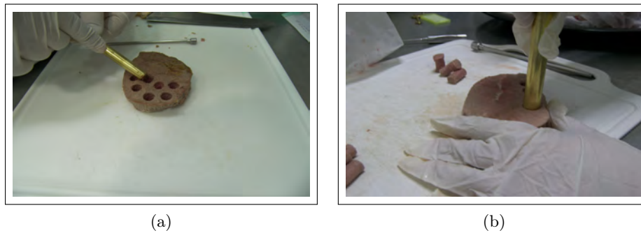
Figura 2.29: Extracción de muestras cilíndricas mediante sacabocado. (a) Extracción en toda la rodaja del músculo Semitendinosus bovino cocido-pasteurizado. (b) Extracción en la periferia de la rodaja del músculo Semitendinosus bovino cocido-pasteurizado.
