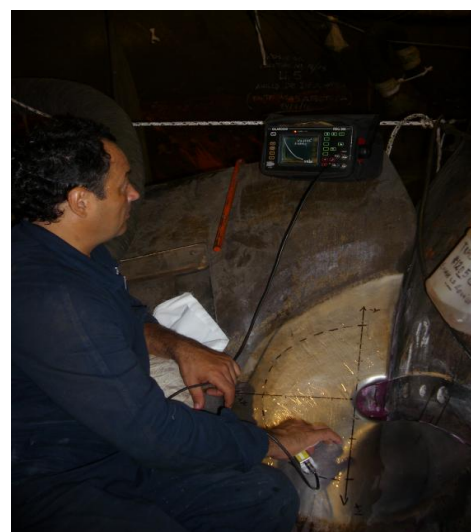
Figura Nro. 3. Inspección por Ultrasonido.
