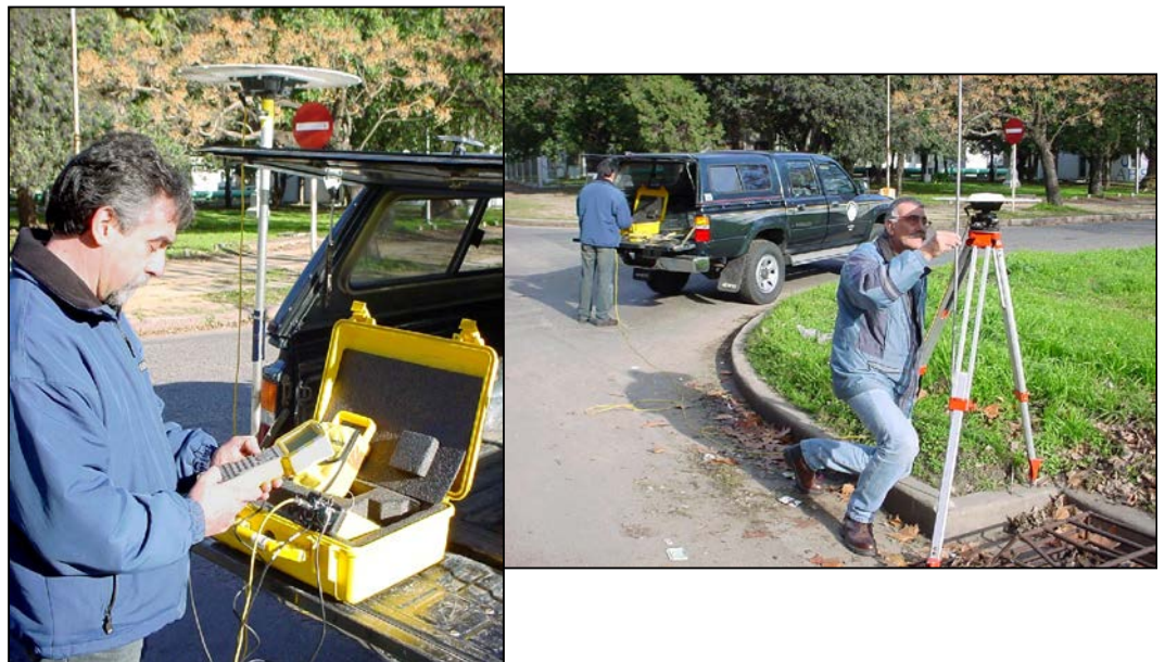
Foto 7.4: Relevamiento con sistema GPS de doble frecuencia.
