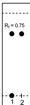
Esquema 4.3.1: Cromatografía en capa delgada de A2EH, 1) antes de los lavados; 2) luego de los lavados.
