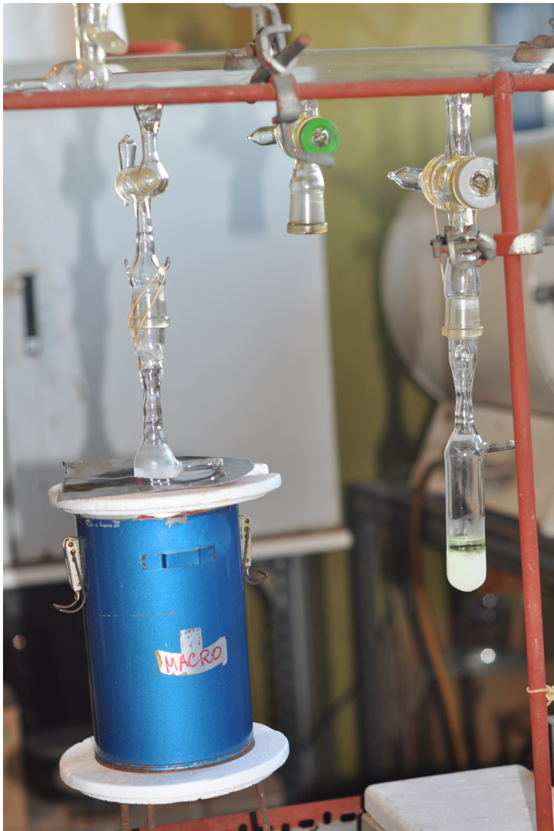
Figura 3.2.1: Imagen de la línea de vacío empleada para realizar reacciones en vacío.
