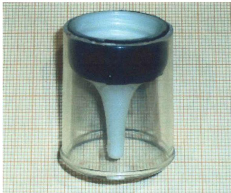
Figura 14: Embudo empleado para introducir el suero liofilizado en las cápsulas de DSC, el mismo tiene la ventaja de contar con una boquilla de salida de diámetro similar a la base de la cápsula, lo que permite ubicar la muestra en dicho lugar, reduciéndose de esta forma los problemas de sellado, agilizando la carga de las muestras y minimizando los problemas de hidratación.
