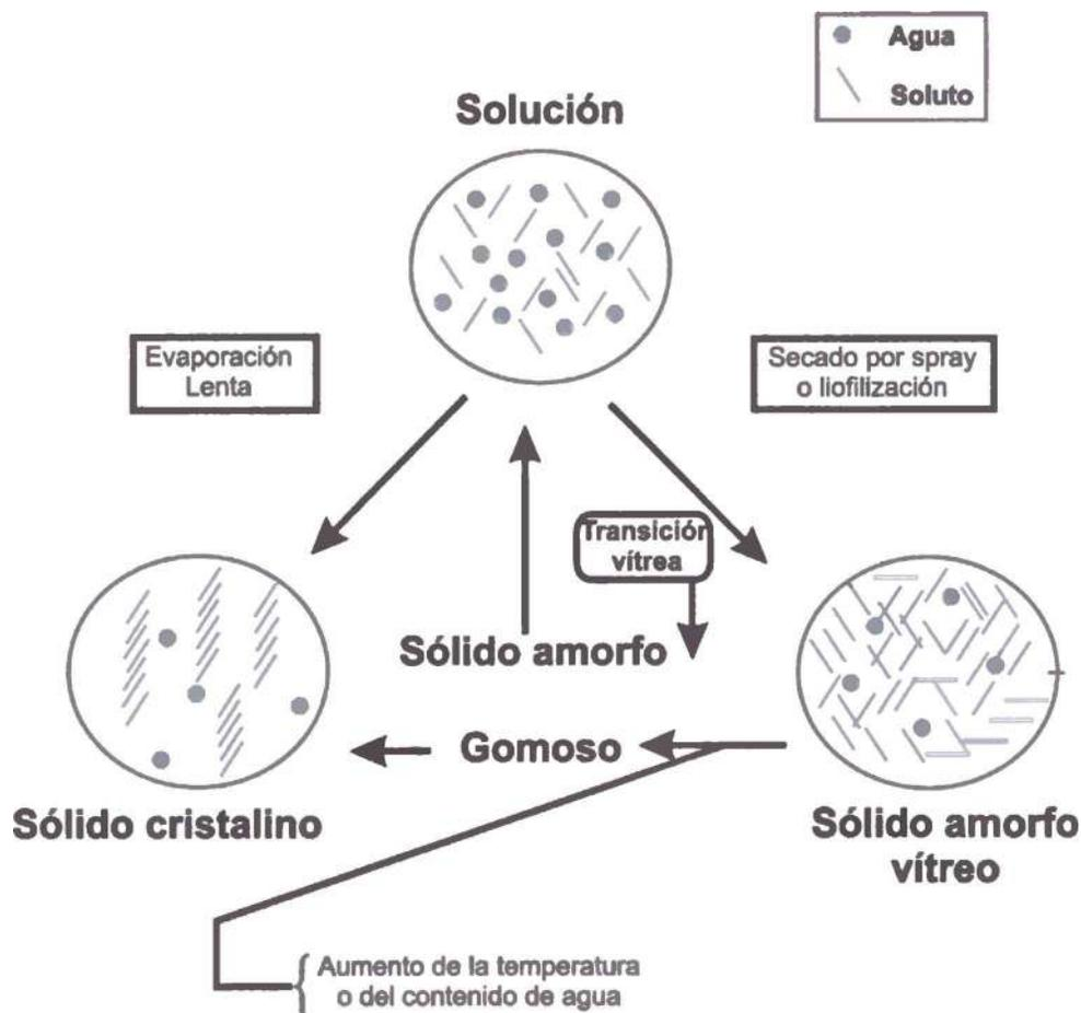
Figura 6: Formación de un sólido amorfo o uno cristalino a partir de una solución (adaptado de Karmas, 1994).
