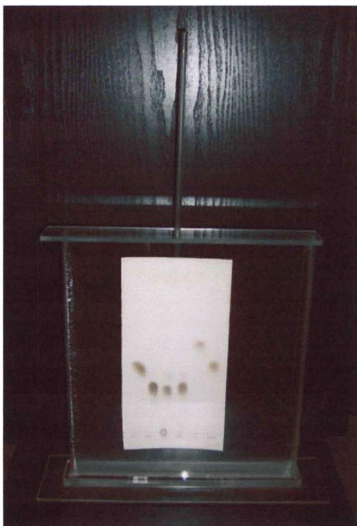
Figura 15: Cuba cromatográfica empleada para TLC. La tapa posee un orificio por el que pasa en forma ajustada una varilla la cual termina en un soporte desde donde se sujeta la placa. Esto permite colocar el conjunto tapa-varilla-soporte al que esta sujeta la placa TLC previamente
