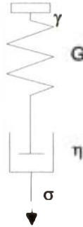
Figura 1-15: Unidad de Maxwell, constituida por un resorte (módulo elástico G ) y un amortiguador hidráulico (viscosidad \eta ) en serie.
