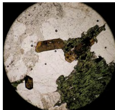
Figura 3.6.3: cristales euhedrales a subhedrales de allanita castaño-anaranjados en un monzogranito (G2). Fotomicrografía 4x, N//.
