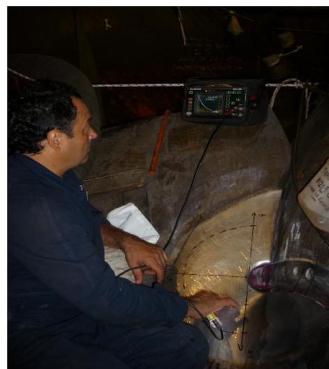
**Figura Nro. 3.** Inspección por Ultrasonido.
