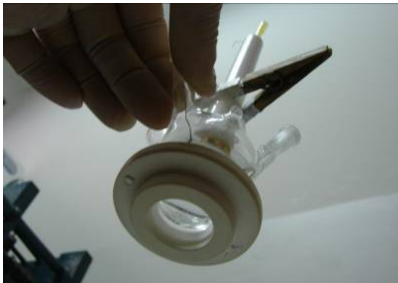
Figura 5.4: Celda electroquímica utilizada para realizar los experimentos de FTIR- in situ , donde puede observarse la ventana de CaF 2 montada en el fondo de la celda y el disco de oro en el extremo de la pieza cilíndrica de teflón.
