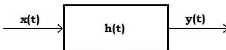
Figura 2.7: Representación esquemática de un sistema LIT.
