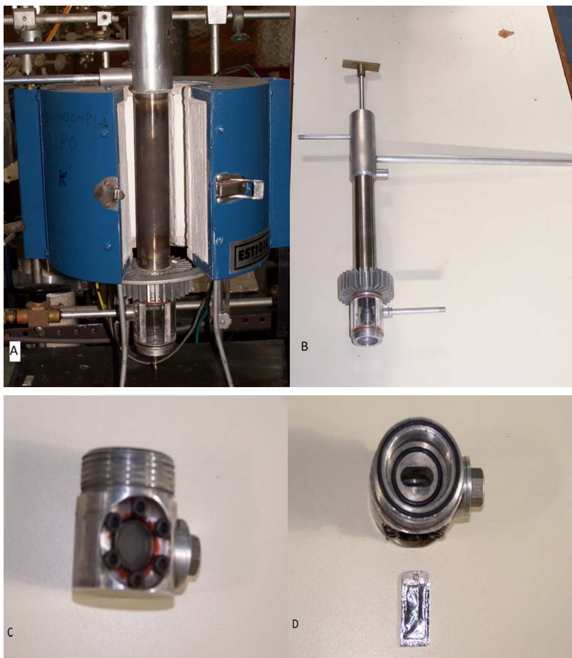
Figura 4.10 – A- Reactor montado dentro del horno, B- Reactor completo fuera del horno, C- Celda con ventana de acrílico, D- Porta muestra que se inserta dentro de la celda para su transporte en atmósfera controlada.
