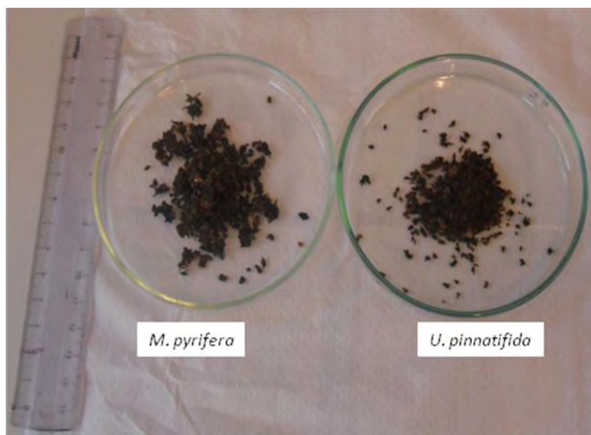
Figura 7. Biomasa de M. pyrifera y U. pinnatifida acondicionada para trabajos de biosorción (1,8- 2,0 mm; tratadas con \text{CaCl}_2 0,2 M).
