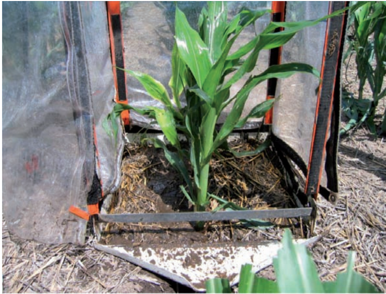
Figura 8. Detalle de la parcela de medición del simulador de lluvia
