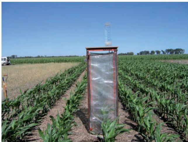
Figura 7. Simulador de lluvia para determinaciones de infiltración, escurrimiento y erosión
