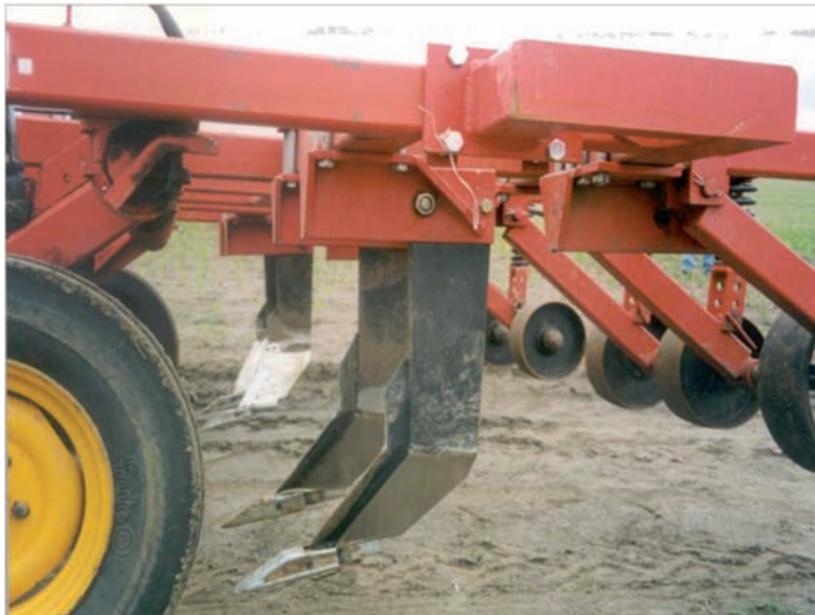
Figura 13. Subsolador para aflojar suelos compactados
