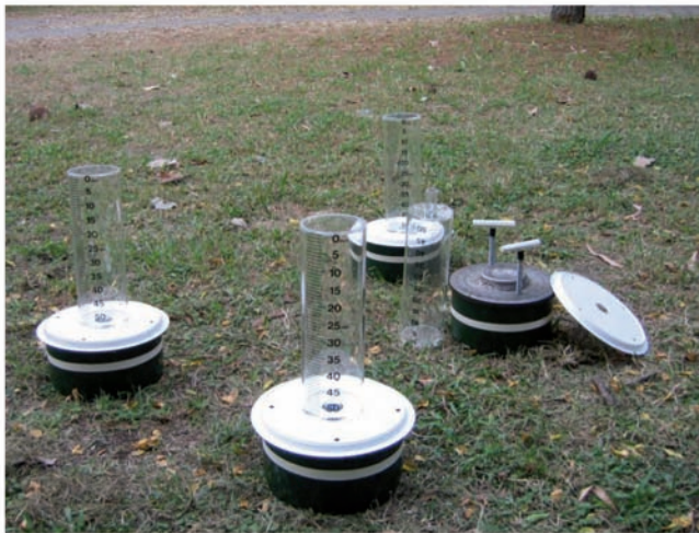
Figura 6. Infiltrómetros de anillo simple construidos en el Instituto de Suelos
