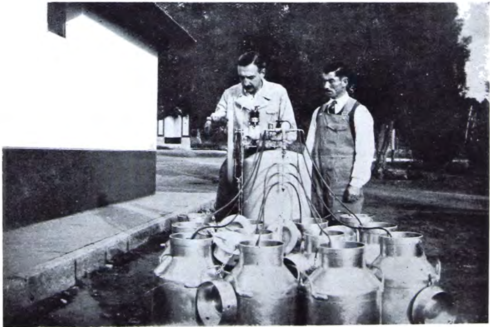
Nº 8 — El encargado del Viviero, Dr. Tomás González Regalado, con un ayudante, probando el funcionamiento de un inyector de aire para transporte de salmónidos a larga distancia.
