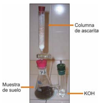
Figura III.3: Sistema Biometer donde se muestran las partes y la ubicación de los componentes que lo forman.
