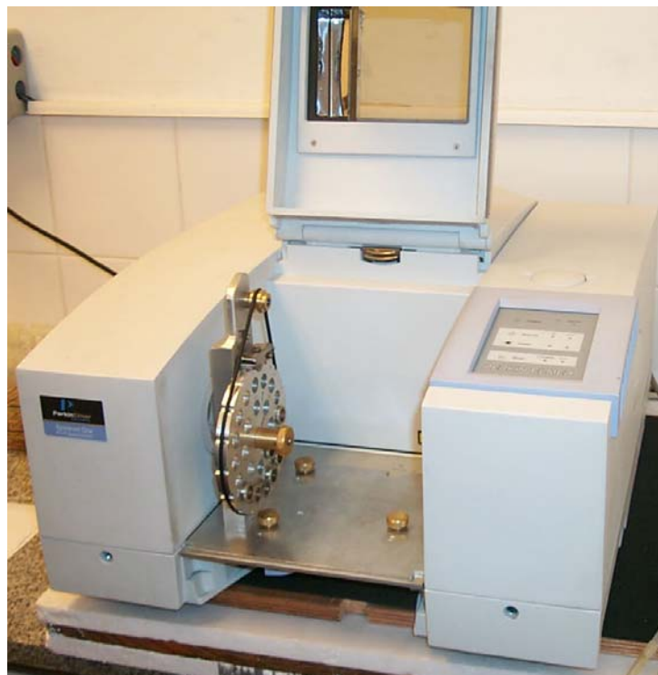
Fig. 2. Espectrómetro FT-IR Perkin-Elmer con modificaciones en la cámara de lectura. En el interior se puede apreciar montada la rueda de acero inoxidable para la lectura múltiples celdas de ZnSe bajo corriente de aire seco.
